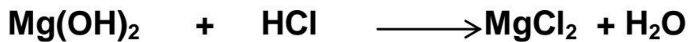
والخطوة الثانية هي فصل  $\text{Mg(OH)}_2$  بالترشيح ثم انحلاله بحامض الهيدروكلوريك لتحويله إلى كلوريد ثم يتم صهر كلوريد الماغنيسيوم وتحليله كهربيا إلى معدن الماغنيسيوم وغاز الكلور .
